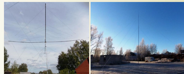
远征所使用的蛛网及80/160m波段垂直天线
